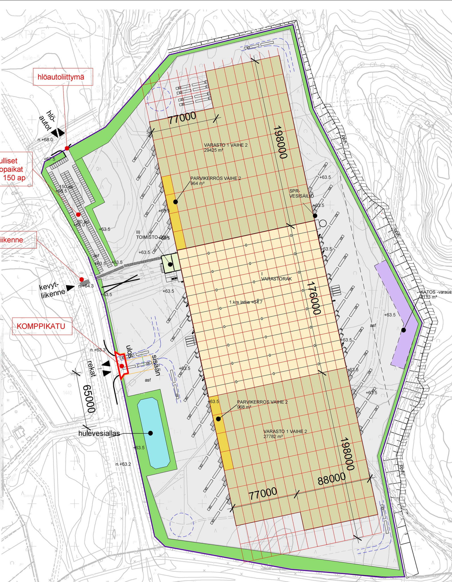
Kolmannessa vaiheessa rakennus, piha-alueet, pysäköintipaikat ja hulevesien viivytysrakenteet on toteutettu kokonaan. Kuva: Arkkitehtitoimisto Siltanen ja Laakso Oy 15.6.2023
